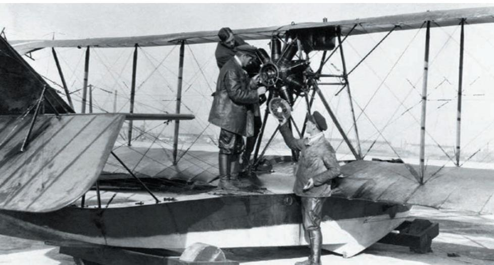
Летающая лодка (гидросамолёт) М-5 конструкции Д.П. Григоровича.
