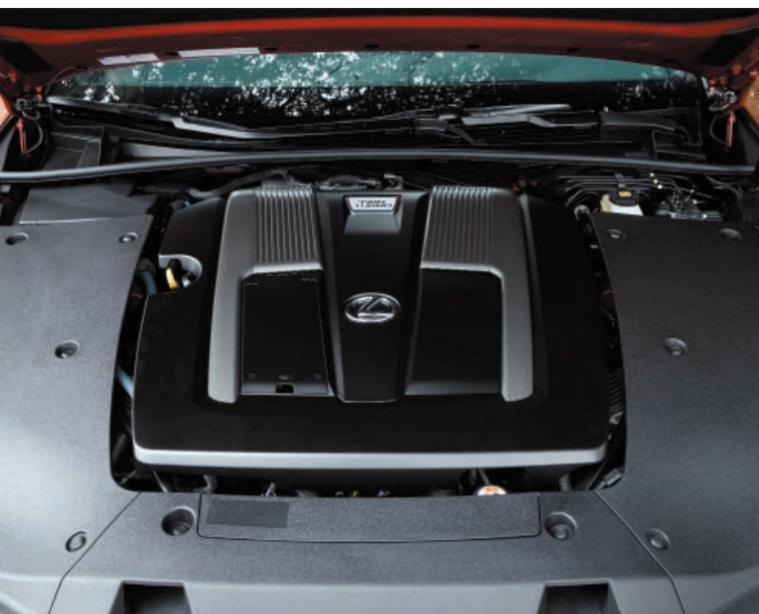
**Модель оснащена новым 3,5-литровым 422-сильным двигателем V6 с двойным турбонаддувом. Крутящий момент – 600 Нм.**
