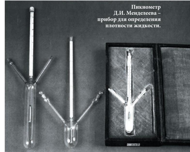
Пикнометр Д.И. Менделеева – прибор для определения плотности жидкости.
