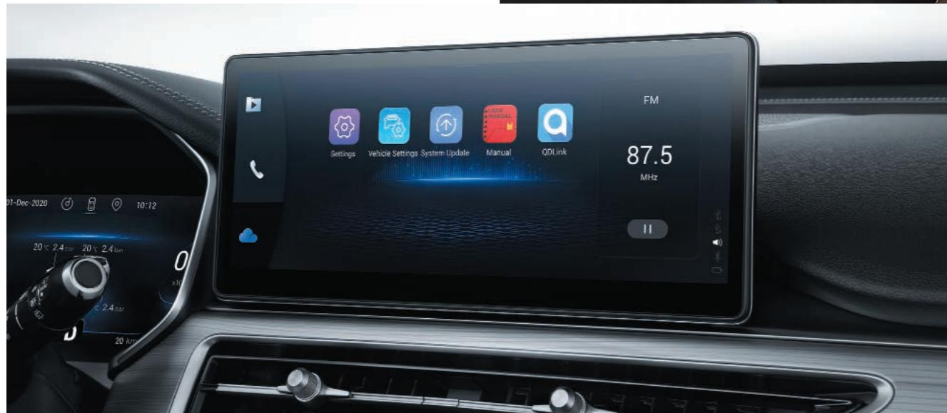
датчик дождя, бесключевой доступ в салон и кнопка запуска двигателя, электрический стояночный тормоз с функцией AutoHold, дистанционный запуск двигателя, круиз-контроль, цифровая панель приборов с 7-дюймовым дисплеем, мультимедийная система с ёмкостным сенсорным 10,25-дюймовым экраном, сенсорная панель управления климат-системой (оба дисплея требуют постоянной протирки тряпоч-
